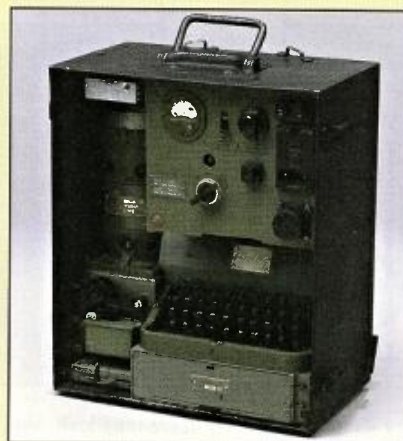
Obr. 2. Feldfernschreiber TBS24 a, polní dálhopis, používaný po válce i u nás
