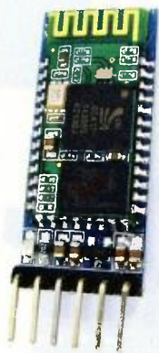
Modul HC 05 a zapojení jeho vývodů (využijí se jen Rx, Tx, GND a Vcc)
