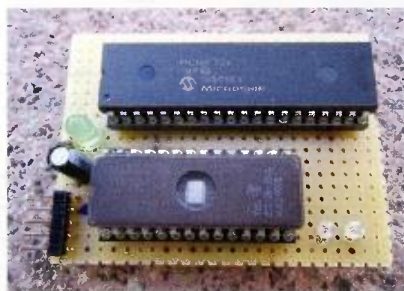
Obr. 24. Pripojenie EPROM 27C128 na zbernicu I 2 C s obvodom popísaným v minulej časti
