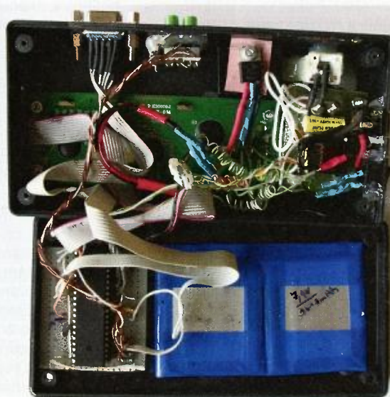
Obr. 2 až 4. Hotový přístroj, pohled na programovací konektor a tlačítka, sonda s GM trubicí a vnitřní uspořádání přístroje
